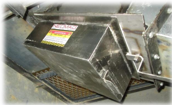
Placa magnética como fondo de chute (Alimento).
