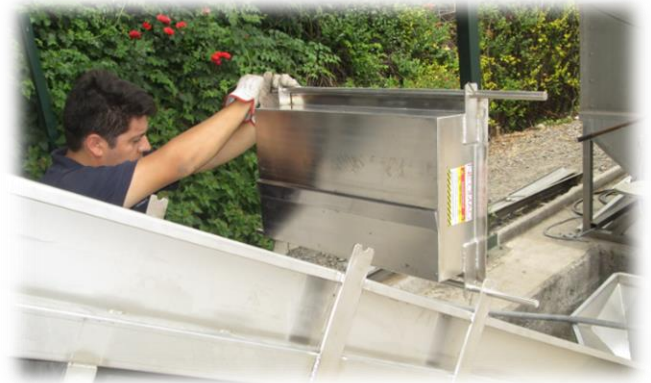
Placa magnética instalada en cinta para vendimia.
